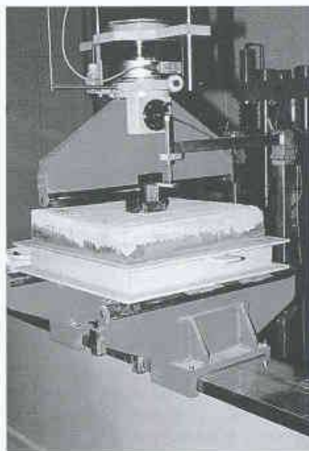
Spritzbetonplatte im Platten-Biegeversuch
