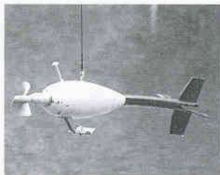
Ein hydrometrischer Flügel mit Gewicht und Stabilisator
