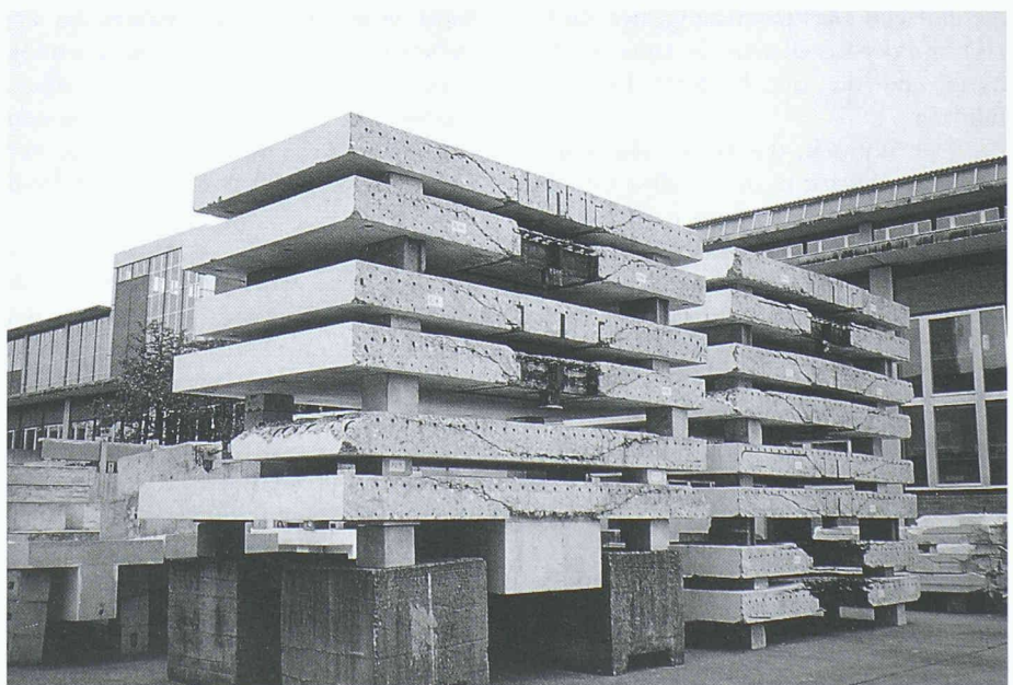
Bruchbild in den zentrisch durchgeschnittenen Versuchskörper
