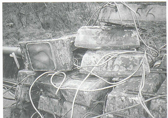
1 Ausgebaute Leuchten mit stark korrodieren Gehäusen aus Aludruckguss
