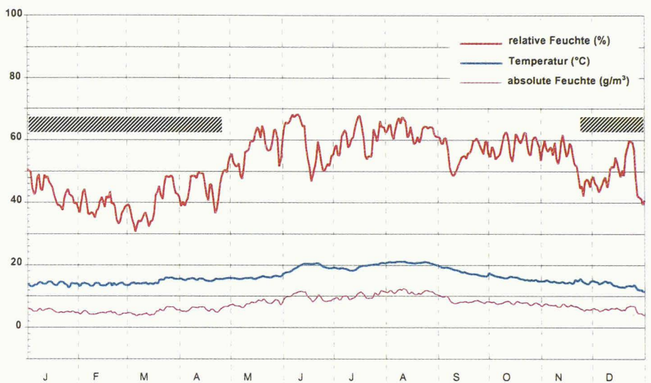
5 Kathedrale Chur. Entwicklung des Innenklimas 1996 (Tagesmittelwerte beim Hochaltar auf +3 m). Die Periode mit starken Salzausblühungen ist als Balken eingezeichnet
