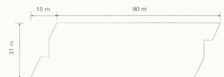
1 Schematische Abbildung des Grundrisses des Hancock Towers (in Anlehnung an Levy/Salvadori, Why buildings fall down, W.W. Norton & Company, New York 1994, S. 200)
