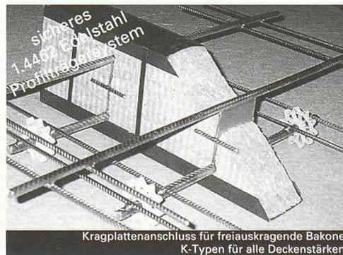
Der **BASYCON**-Anschluss weist ausgezeichnete Wärmedämmwerte ( $k_{fin}$  unter 0,25 W/mK) auf, besteht komplett aus nichtrostendem Edelstahl 1.4462 und ist symmetrisch. Temperaturzwängungen sind im statischen Modell vollständig mitberücksichtigt und das steife Profilträgersystem erreicht in Bruchversuchen 70% höhere Lasten als rechnerisch ermittelt!
