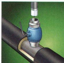
**Pan-Isovit-Anbohrtechnik.** Rasches und günstiges Anschliessen ohne Entleeren an in Betrieb stehenden Leitungen, für Anschlussleitungen DN 20-100.
