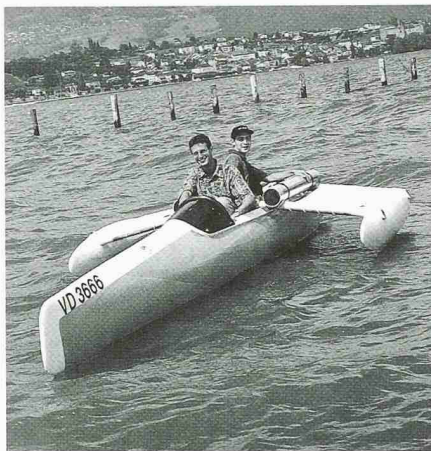
Dank Brennstoffzellen gleitet der Trimaran sanft und leise über den See. Im zylinderförmigen Behälter wird der umweltfreundliche Energieträger Wasserstoff mitgeführt (Bild: CH-Foschung/Gian Vaitl)
