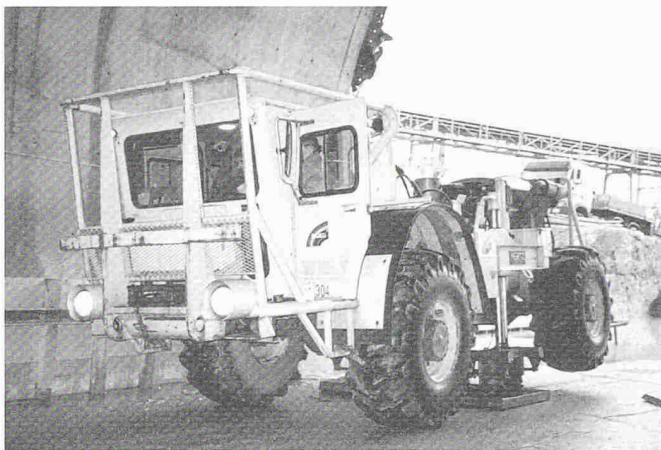
VibroScan-Schwingungsgenerator zur Simulation von Verkehrserschütterungen
