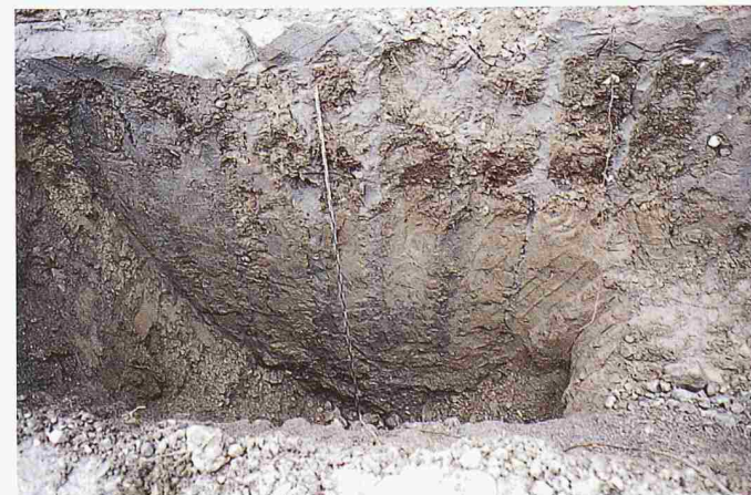
Ausgrabung der Versuchsstrecke. Man erkennt sehr schön die Vollständigkeit und die Rippen, die durch die Form der Rüttelbohle gebildet wurden
