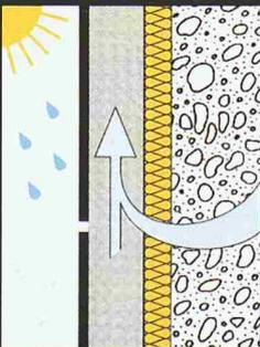
Durch vorgehängte hinterlüftete Fassaden wird das «Atmen» der Aussenwand nicht behindert. Der wesentliche Vorteil von Fassadenplatten ist die ungehinderte Abführung der Bau- und Wohnfeuchte.
