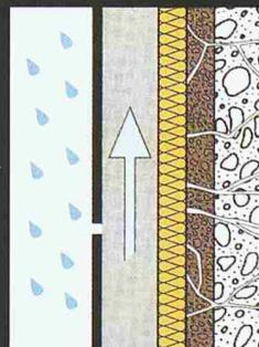
Beim Sanieren der Fassade mit vorgehängten Fassadenplatten muss die bestehende Wandoberfläche vorher nicht mehr saniert werden. Ein wichtiger Zeit- und Kostenfaktor.
