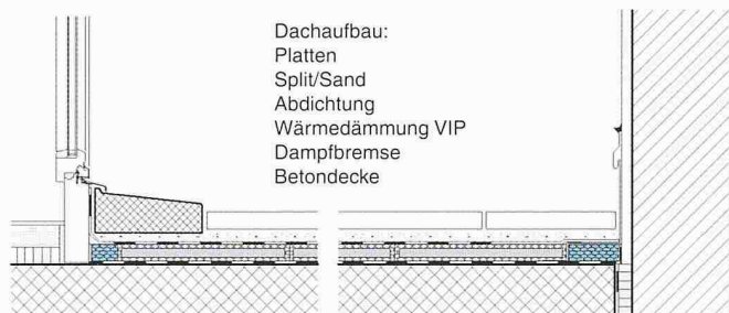
Prinzipieller Aufbau der ausgeführten Terrassendämmung
