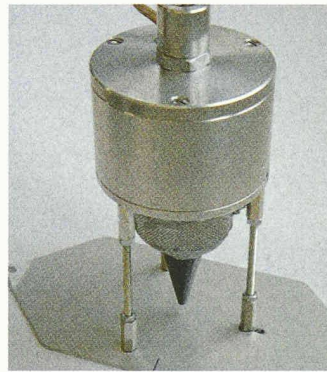
Ein Modelllautsprecher mit einem Durchmesser von 6,5 cm und einer Höhe von 12 cm
