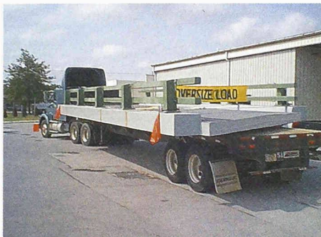
Vorgefertigte FRP-Brückenplatte (Bild: Hardcore Composites)
