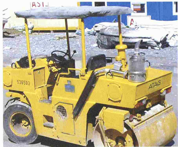
Der Partikelfilter an dieser Strassenwalze reduziert den Schadstoffausstoss – insbesondere an Russ – an der Quelle (Bild: BWL/Leuenberger)
