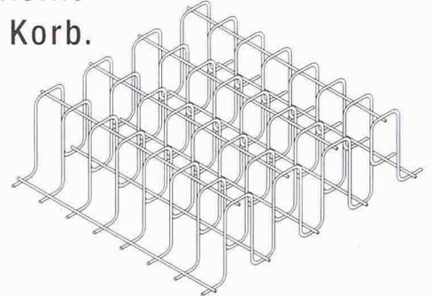
FIDECA®, die neuartige Schubbewehrung (Euro Pat.) von Fischer Rista, gibt Gebäuden schon beim Bauen mehr Sicherheit. Die Schubkörbe mit ihrer wellenförmigen Konstruktion ermöglichen eine kontinuierliche Verankerung. So wird das Risiko des Durchstanzens durch Bodenplatten oder Betondecken ausgeschlossen.
