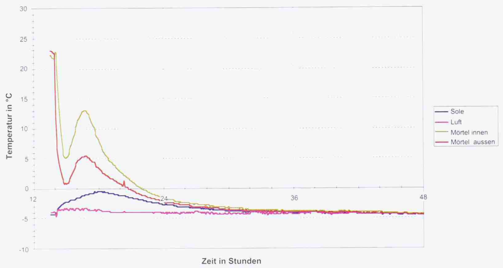
Typischer Temperaturverlauf eines schnell abbindenden Anker Mörtels. Die Temperatur bleibt vor der Hydratation immer über dem Gefrierpunkt. Der nach 15 Stunden zu beobachtende Temperaturanstieg erfolgt wegen der frei werdenden Abbinde Wärme (Bild: -... Konrad Moser)
