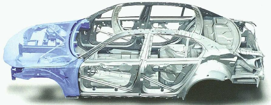
geren Laserschweißverfahrens im weitgehend automatisierten Zusammenbau. Als Folge der beim Laserschweißen kleineren Wärmeinbringung und damit des geringeren Verzugs lässt sich zusätzlich eine höhere Qualität der Gesamtkonstruktion erreichen.
