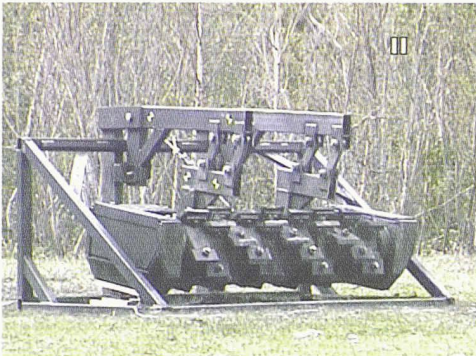
Digger-Fräse: Die Rodungsfräse wird auf Unzerstörbarkeit bei Explosionen getestet
