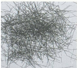
Mikrostahlfasern mit einem Durchmesser von 0,2 mm, einer Länge von 12 mm und einer Zugfestigkeit von 2000 N/mm 2
