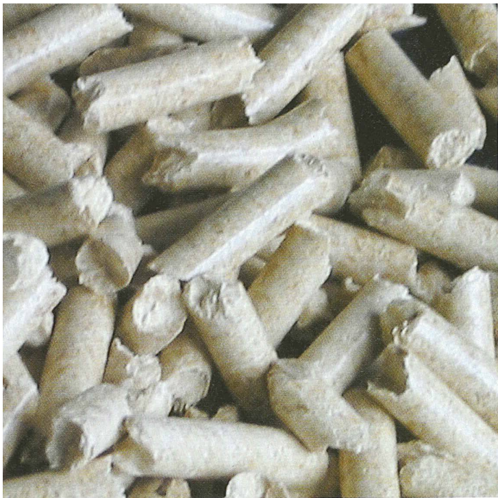
Pellets bestehen aus gepresstem Sägemehl und Hobelspänen und sind etwa fingergröss. Eine Holzfeuerungsanlage mit Pellets ist ähnlich leicht zu bedienen wie eine Öffeuerung (Bild: Holzenergie Schweiz)
