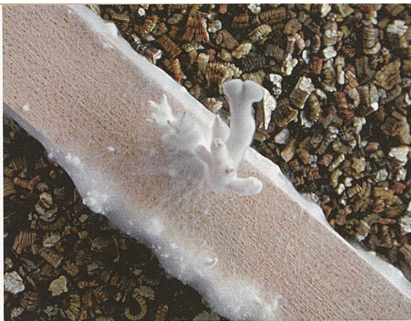
Die physikalischen Eigenschaften der verpilzten Holzproben wurden in den Labors analysiert (Bilder: Empa)
