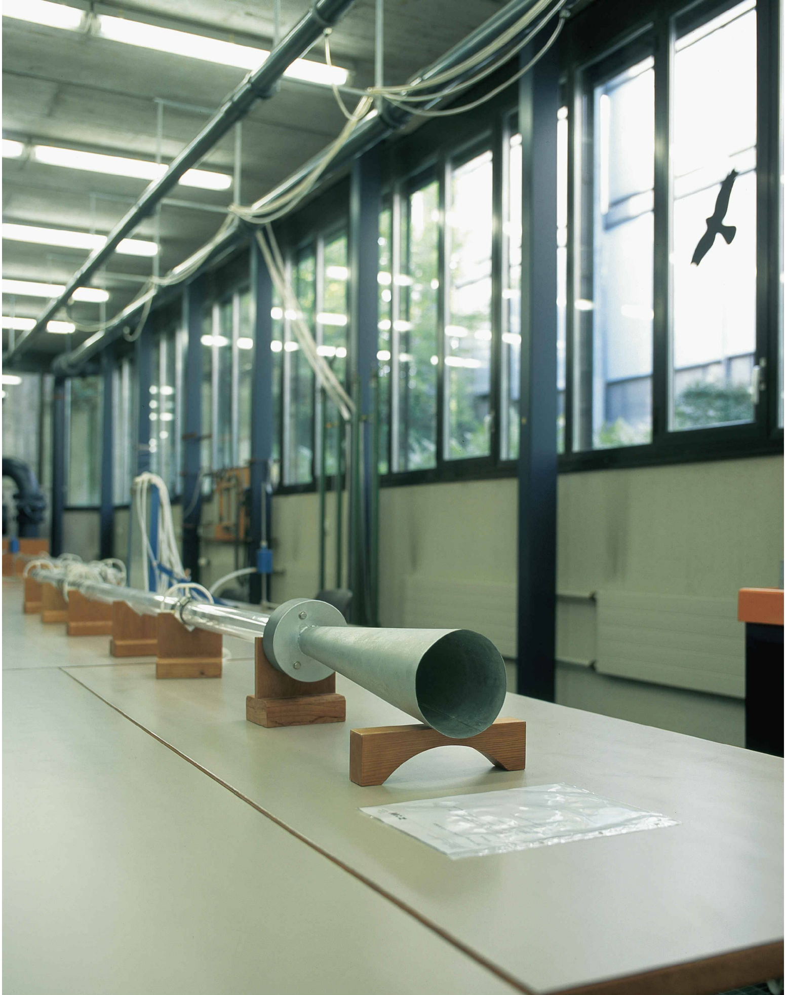
7 Luftströmungsmodell im Wasserbaulabor (Bild: Christian Schwager)
