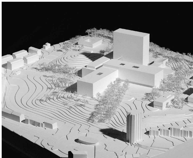
Projekt mit winkelförmigem, niedrigerem Anbau. Längere Wege und teilweise sehr grosse Gebäudetiefen sind die Nachteile dieses Konzeptes (Atelier WW + KSP Engel und Zimmermann)
