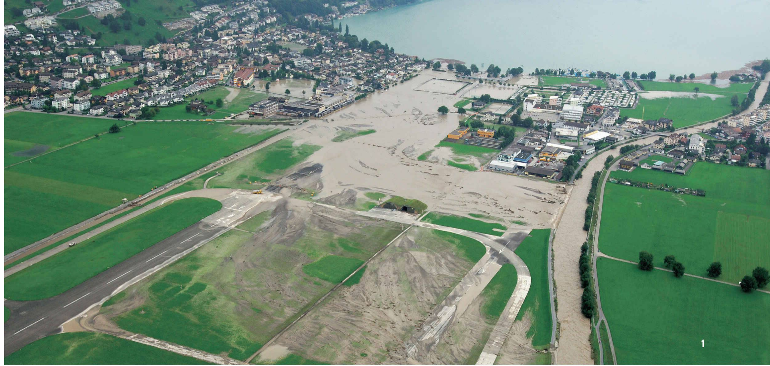
Die Engelberger Aa beim Abklingen des Hochwassers im Jahr 2005. Das überschüssige Wasser verlässt das Flussbett an den vorgesehenen Entlastungsstellen und strömt über den Entlastungskorridor zwischen Ennetbürgen und Buochs in den Vierwaldstättersee (Bild: Schweizer Luftwaffe)
