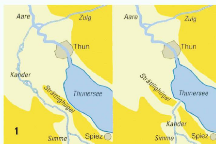
1 Kanderdurchstich bei Spiez, links Situation vor 1714 (Bild: D. Vischer)
