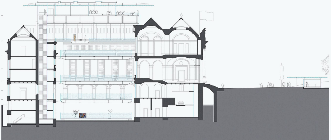
03 Ergänzende Einbettung in Vorhandenes mittels Glas, Licht und präziser Details: das in den Museumshof hineingebaute Forum. Längsschnitt. Das EG und das 1. bis 3. OG enthalten Ausstellungsräume sowie einen Mehrzwecksaal, im 5. OG liegt das Restaurant (Bilder: Jean Nouvel)
