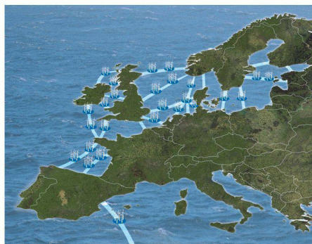
02 Das Supergrid-Konzept des irischen Energiekonzerns Airtricity sieht vor, Offshore-Windparks mit Unterseekabeln untereinander und mit den nationalen Netzen verbinden (Bild: Airtricity)
