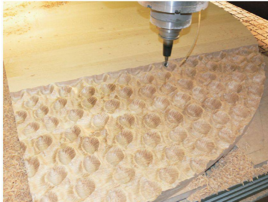
Türdoppel zu Brandschutztüren des Landesmuseums in Eiche gefräst im Auftrag der Ernst Frank AG
