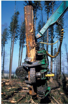
Der Greifarm eines Vollernters packt einen Baum und trennt die Äste vom Stamm. In Schweizer Wäldern sind solche Maschinen immer häufiger anzutreffen. Neue Regeln sind nötig, um auch künftig eine naturnahe Waldwirtschaft zu gewährleisten (Foto: AURA/Emanuel Ammon)
