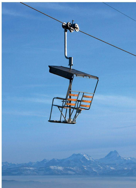
01 Einer der quer zur Seilachse verlaufenden Sessel der Seilbahn Weissenstein im Kanton Solothurn. Die Bahn wurde in den 1950er-Jahren von der Firma Von Roll erbaut (Foto: KEYSTONE/Martin Ruetschi)
