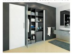
«HAWA-Concepta» ist ein System für Holzund Glastüren, das auf eine Bodenführung verzichtet und eine flexible Raumnutzung ermöglicht. Auch in Sachen Abmessungen ist es flexibel einsetzbar: Türhöhen bis 2850 mm, Breiten zwischen 300 und 900 mm, Holzdicken 19 bis 50 mm, bei Glas (Einscheibensicherheitsglas) 8 mm. Gleichzeitig erhält man im Schrank einen grösstmöglichen Stauraum, weil zum Beispiel eine bis zu 30 mm dicke Tür nur eine maximale Nischenbreite von 55 mm benötigt.
