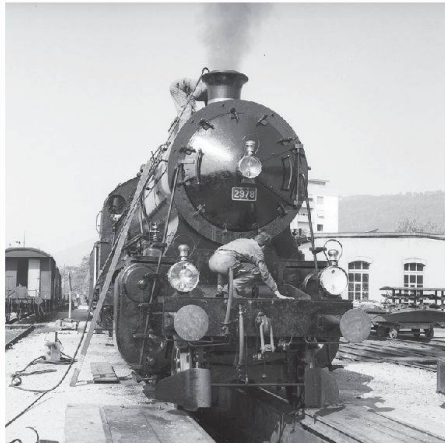
01 Aus dem Fotoarchiv von SBB Historic: Werkstätte Biel, Hauptrevision der Dampflokomotive C 5/6 2978 im Jahr 1968 (Foto: SBB Historic)
