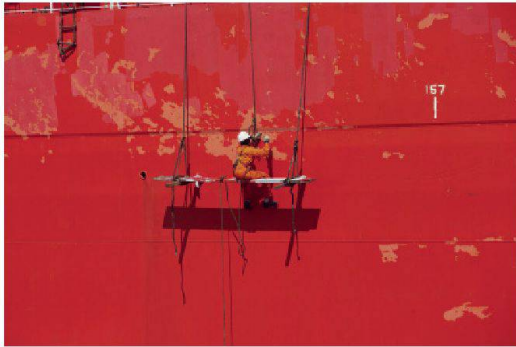
Notwendige Lackpflege: Ein Werftarbeiter im Hamburger Hafen bessert den Anstrich einer Bordwand aus. (Foto: Caro Fotoagentur/ Andreas Muhs)
