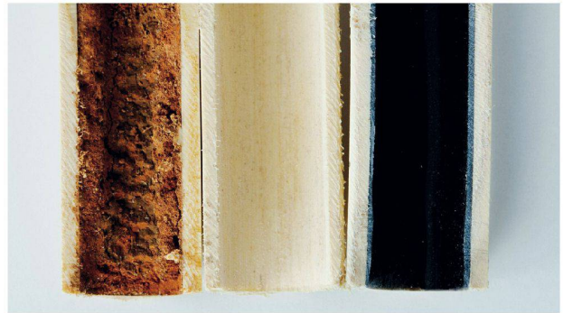
Heizungsrohr vor, während und nach der Sanierung.
