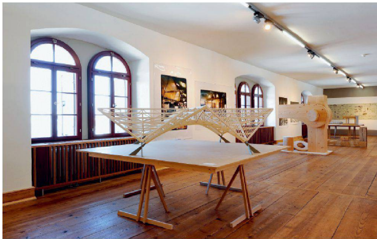
Modell 1:50 der Dachkonstruktion der Eishalle Davos (1979), dahinter Demonstrationsmodell 1:1 eines Knotens der Tragkonstruktion des Tamedia-Gebäudes in Zürich.
