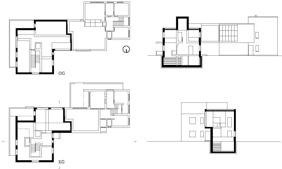
Grundrisse und Schnitte des Meisterhauses Moholy-Nagy , Mst. 1:400.
