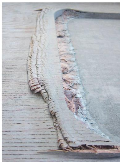
Damian Lüthi prüfte den Schubwiderstand von Taschenkerben in Holz-Beton-Verbunddecken aus Buchenholz. Die Prüfeinrichtung (**ganz oben**) leitet eine horizontale Kraft in das Holz ein, die wiederum in den Beton eingeleitet wird. Die Geometrie der Betontasche kann so gewählt werden, dass ein duktiler Holzdruckversagen (**oben**) eintritt, womit das gesamte Deckensystem gegenüber einen fragilen Bruchbild robuster wird.
