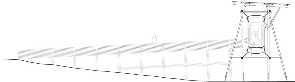
**Querschnitt durch die Holzkonstruktion:** Sie sollte so schlank wie möglich ausfallen, Schrauben verbinden die einzelnen Streben. Mst. 1:200.
