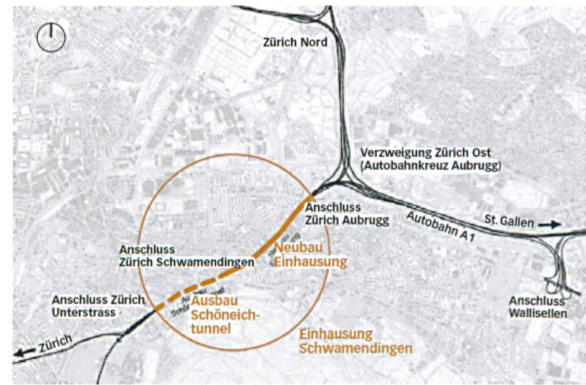
Die A1 soll zwischen Autobahnkreuz Aubrugg und dem Schöneichtunnel von einem Tagbautunnel umschlossen werden.
