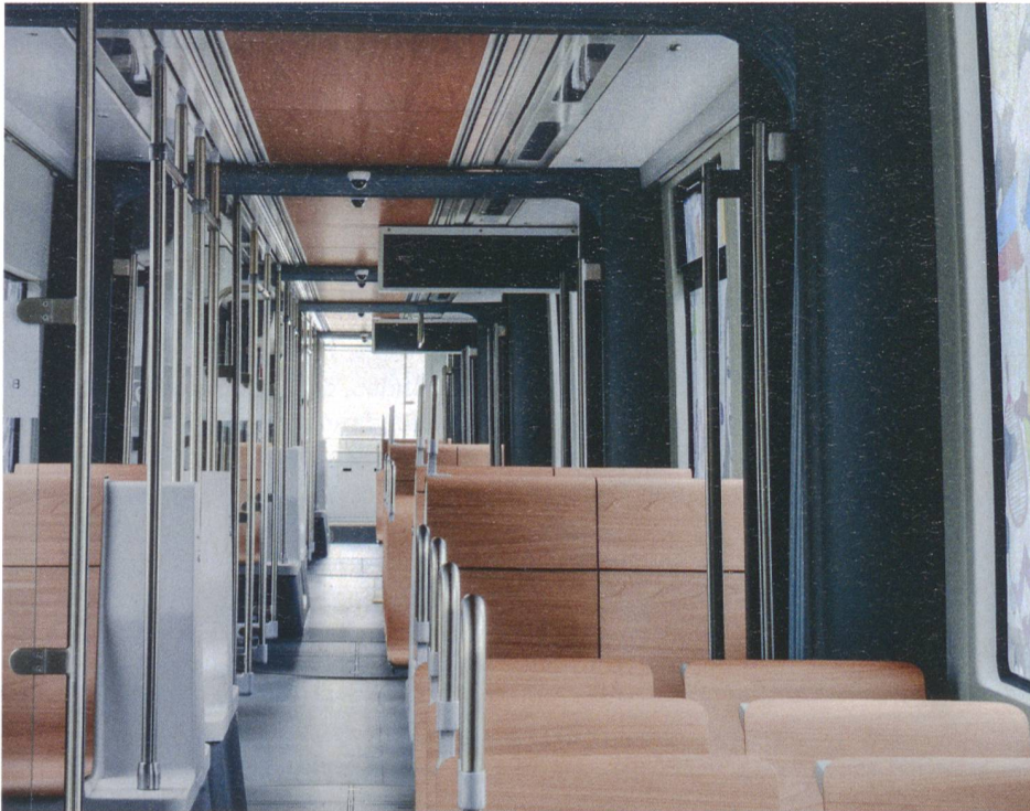
Die Sitzschalen bestehen aus Buche. Damit das Holz hygienisch, kratz- und rutschfest ist und auch länger schön bleibt, wird es mit einer schützenden Kunstharzschicht versehen. Die Dreierbestuhlung ergibt sich aus der in Basel üblichen Fahrzeugbreite von 2.30 m (Spurweite: 1000 mm).
