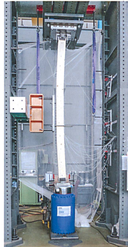
Knickversuche an Brettschichtholz-Stützen an der ETH Zürich
