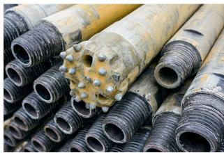
Hat es genug Platz für weitere Erdwärmesonden? Die geothermische Nutzung des oberflächennahen Untergrunds wird konfliktfrei verdichtet werden können, wenn die bestehenden rechtlichen und planerischen Rahmenbedingungen angepasst werden. Im Bild: Bohrkopf und -gestänge für eine Erdwärmesonde.
