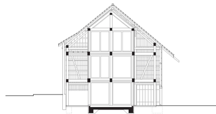
Schema des Holztragwerks mit Betonkern.
