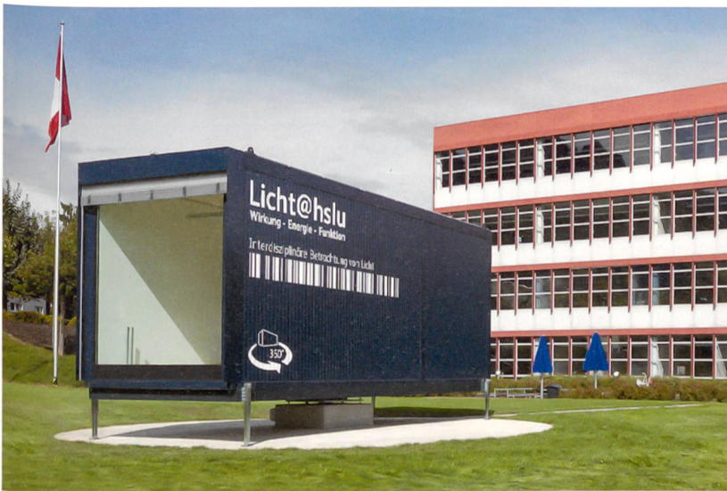
Im Lichtmesscontainer an der Hochschule Luzern können Versuchsreihen zu Tageslicht in Innenräumen vorgenommen werden.
