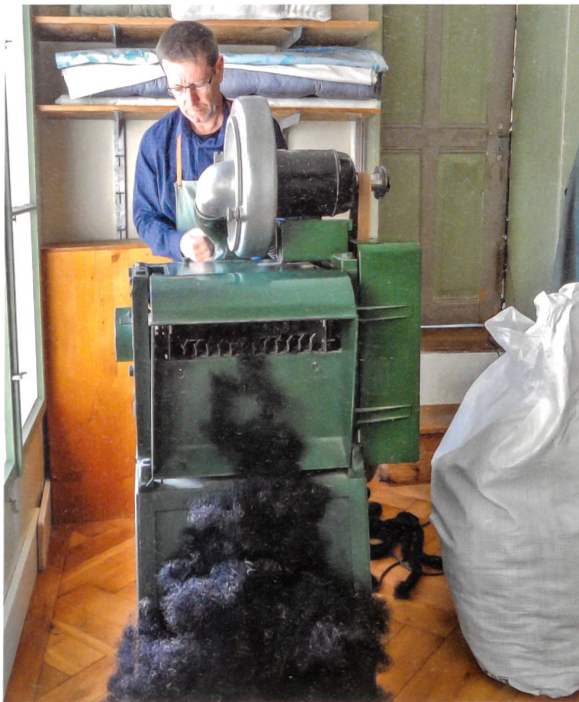
An der Zupfmaschine werden die gedrehten Rosshaarstränge aufgezwirbelt und so für die Füllung vorbereitet. Wird ein ganzer 13-kg-Sack aufgezpft, ist der gesamte Fussboden der Werkstatt mit Rosshaar bedeckt.
