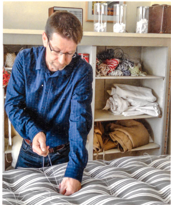
Die Boufettes sorgen dafür, dass die Füllung am richtigen Ort bleibt und sich durch den Gebrauch der Matratze keine Mulden bilden. Hier werden sie noch einmal nachgespannt, anschliessend die Fäden entfernt, dann ist die Matratze bereit zum Ausliefern.
