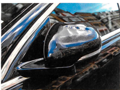
Zwei Stunden pro Tag streiften die gebündelten Sonnenstrahlen durch die Eastcheap Street. Sie liessen u. a. Spiegel und Heck eines Jaguar schmelzen.
