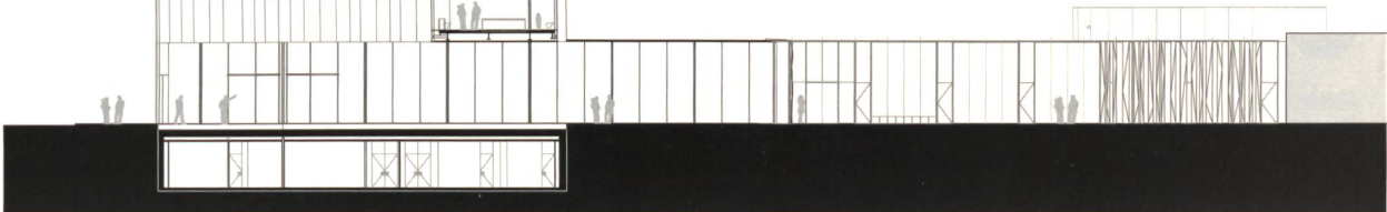
Unten: Schnitt, Mst. 1:200, die drei Obergeschosse bilden zueinander versetzte Ebenen. Die Treppe zwischen 2. und 3. Obergeschoss ergibt ein offen gestaltetes Auditorium. Im Untergeschoss befinden sich ein Hörsaal und ein Ruheraum. Darüber liegt die Passage zum Innenhof.
