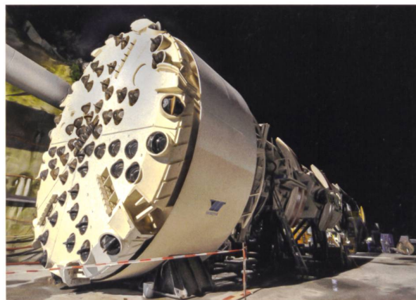
Tunnelbohrmaschine zur Erstellung des Zugangsstollens 1.
